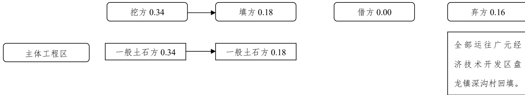
图 2.5-2 土石方流向框图 (单位: 万 m 3 )
