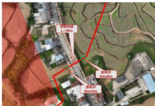
小伏路 (县道) 1顶管穿越
