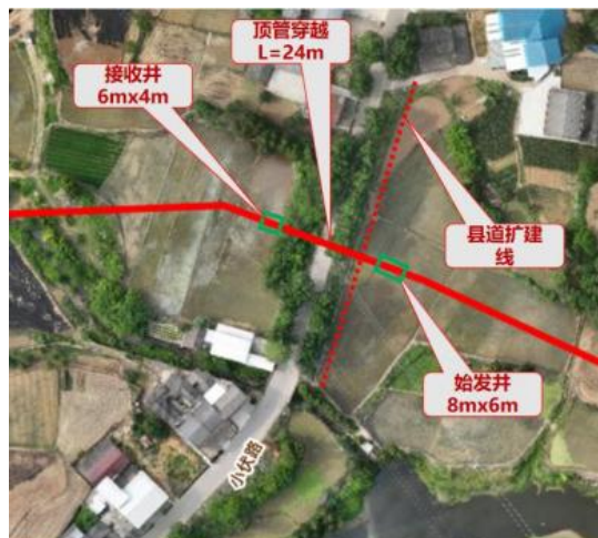
小伏路 (县道) 2顶管穿越
